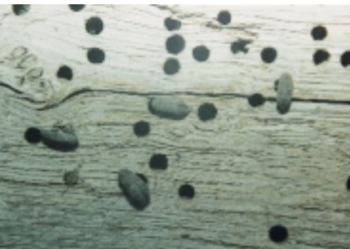
Bonte knaagkever - hout met uitvliegopeningen en uitgevlogen kevers
